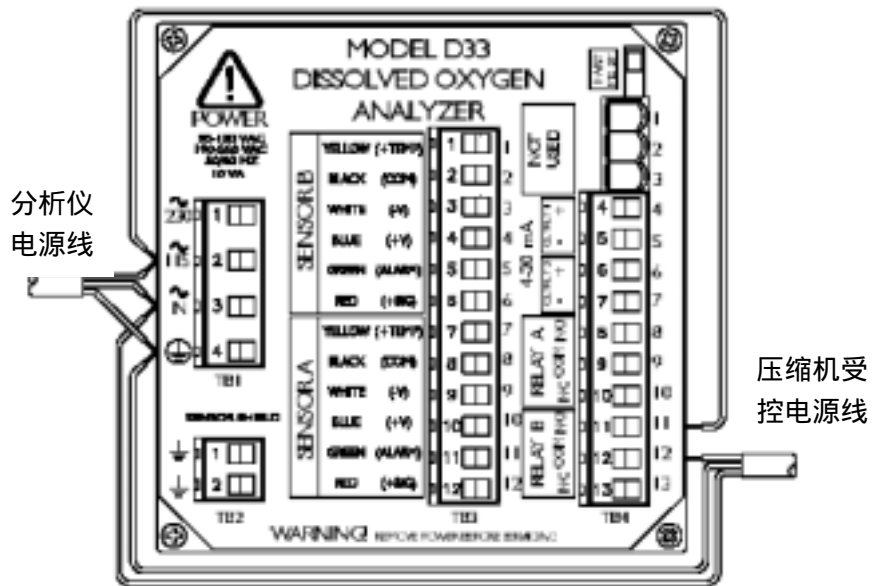
图 2-10 D33 分析仪与空气压缩机的接线
